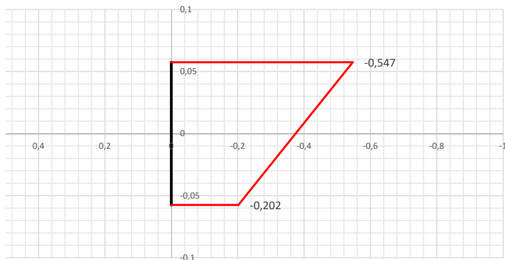
Razporeditev tlačnih napetosti po prerezu
